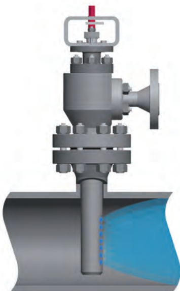
Die Reihenfolge der Öffnung der Düsen ist konstruktiv in der Düsenspindel festgelegt. Die Einspritzung des Kühlwassers beginnt stets mit den in der Mitte des Einspritzkühlers angeordneten Düsen.
